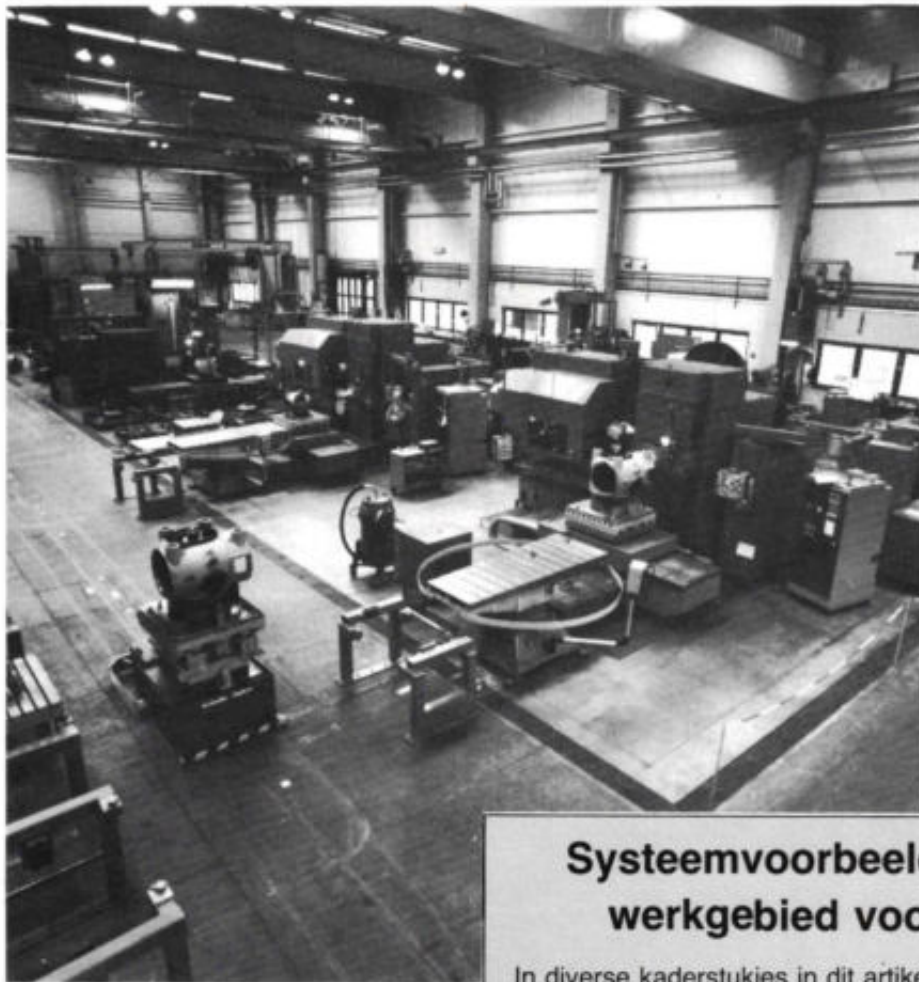
Afb. 4. Bij discontinu verloopende processen zien we een heel andere bedrijfsopbouw dan bij de procesindustrie. We beginnen met een wat eenvoudiger type flexibele automatisering, zoals in gebruik bij de Westfalia Separator fabriek in West-Duitsland. Er staan een aantal numeriek bestuurd bewerkings-eenheden opgesteld, die door AGV's (Automatisch Geleide Voertuigen) worden voorzien van de nodige onbewerkte werkstukken. De afvoer van bewerkte stukken geschiedt op dezelfde manier.
