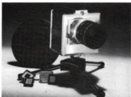
Compacte industriële matrixcamera TN2509, uitgerust met een CID-beeldsensor (foto: General Electric).
