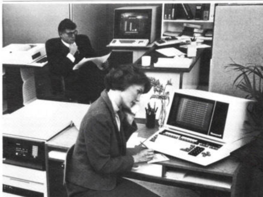
Afb. 18. Even een uitstapje naar een belovend vakgebied; de gebouwenautomatisering. Deze systemen zouden eventueel mede door hun opzet kunnen worden ingepast in een compleet managementsysteem. Hier een voorbeeld van het fabriek Honeywell, namelijk de Delta 5200, waarin ook gedistribueerde intelligentie wordt gebruikt. In de toekomst zou het totale managementsysteem van een bedrijf er wel eens behoorlijk op kunnen gaan lijken qua verschijningsvorm.
