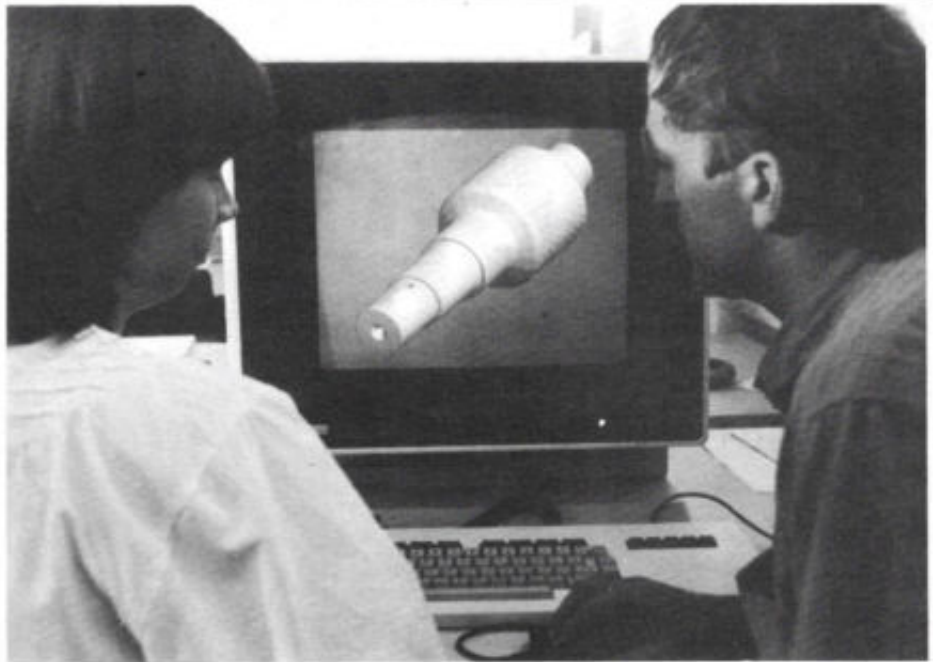
Afb. 12. Hoewel veel numeriek bestuurde werktuigen nog werken met ponsbandinvoer voor de geometrische en technologische informatie, is het ook mogelijk om dit informatiemedium te laten vervallen door directe koppeling van de besturing met een werkstation of volledig CAD-systeem. In veel gevallen worden deze werkstations op basis van een PC opgebouwd. Hier zien we weer een oplossing van Siemens, waarbij op het scherm een ongeveer identiek werkstuk als in de vorige figuur is afgebeeld. Maar hier op dit station, met een 32-bit processor en een behoorlijke dosis software, is het werkstuk in 3D en kleur te zien.
