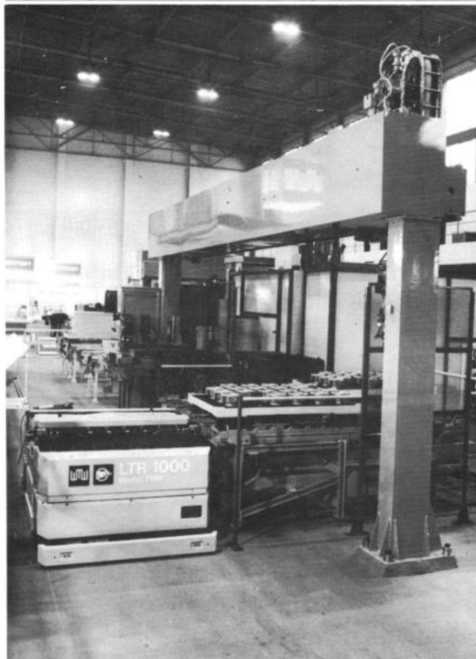
Afb. 5. Een eenheid uit de flexibele productie-automatisering kan er uitzien als deze WMW-cel. Rechts op de foto zijn een paar bewerkingseenheden opgesteld, waarvan de bewerkte werkstukken met behulp van een portaalmanipulator worden opgepikt en op een pallet worden geplaatst. De pallet staat op een stukje rollenbaan, waartegen een AGV kan worden geplaatst. Staat deze op zijn plaats en is de pallet vol, dan wordt er een seintje aan een PLC gegeven, waarna de rollenbaan in werking wordt gesteld en de pallet op de AGV terechtkomt. Zodra dit proces is afgelopen wordt de weg elektronisch vrijgegeven voor de AGV om naar de volgende bestemming te rijden.
