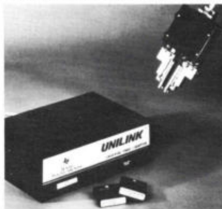
Afb. 19. De nieuwe Unilink Universal Tiway I Adapter van Texas Instruments kan ook een hulpmiddel betekenen voor het koppelen van besturingsapparatuur van zeer verschillende komaf. Voor de vertaling in en uit de gebruikte coderingen van die apparatuur en aanpassing aan MAP-protocollen wordt gebruik gemaakt van een vertalingsprogramma in ROM, dat heel eenvoudig door inpluggen kan worden aangepast aan de te koppelen apparatuur.
